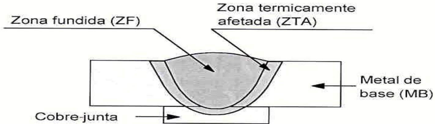
Figura 7 Seção transversal de uma solda de topo por fusão (esquemática)
