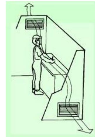
Sistema de extracción mediante un recinto acotado
